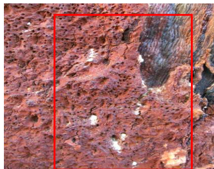
Le nombre de trous de platype par m 2 levé : indice de l'intensité d'attaque retenu
