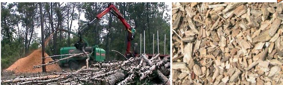
Opération bord de piste, après exploitation. Plaquettes projetées dans des semi-remorques ou au sol pendant les phases d'attente des camions. Matériel : Jenz HEM 560 (280 cv) Ø max 56 cm + camion et grue équipée d'un grappin. Rendement : 145 m<sup>3</sup>/jour ou 435 map/jour
