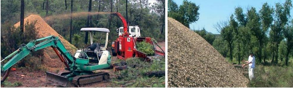
Opération bord de piste, en parallèle de l'exploitation. Plaquettes projetées au sol. Matériel : Biber 7 (150 cv) Ø max 35 cm + petite pelle équipée d'un grappin. Rendement : 57 m<sup>3</sup>/jour ou 170 map/jour [map : m<sup>3</sup> apparent plaquette]
