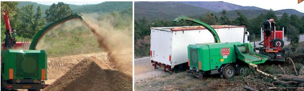
Opération bord de route, après exploitation. Plaquettes projetées dans des semi-remorques de 90 m<sup>3</sup>. Matériel : Jenz HEM 560 (280 cv) Ø max 56 cm + camion et grue équipée d'un grappin. Rendement : 160 m<sup>3</sup>/jour ou 480 map/jour
