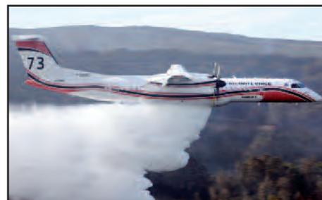
Avion de ligne à l'origine, ce biturbo-propulseur canadien a été transformé en bombardier d'eau. Le réservoir contenant l'eau ou le retardant (10 T.) étant amovible, hors période « feux de forêts », ces deux aéronefs assurent des missions de projection de détachements pour conduire des missions de Sécurité civile (64 hommes ou 9 tonnes de matériels). En 2010, il est intervenu en configuration bombardier d'eau en Russie, en Israël, et à la Réunion ■
