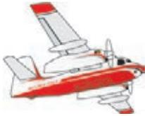
À l'inverse des Canadair, les Tracker sont armés en eau au sol. Ils disposent d'une capacité d'emport moyenne de 3 300 litres et sont utilisés
