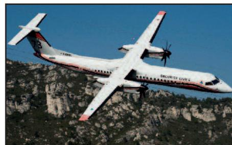
Avion de ligne à l'origine, ce biturbo-propulseur canadien a été transformé en bombardier d'eau. Le réservoir contenant l'eau ou le retardant (10 T.) étant amovible, hors période « feux de forêts », ces deux aéronefs assurent des missions de projection de détachements pour conduire des missions de Sécurité civile (64 hommes ou 9 tonnes de matériels). Depuis 2010, ils interviennent en configuration bombardier d'eau à la Réunion. ■
