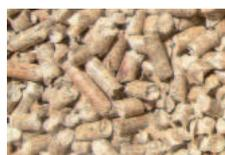
**Le granulé de bois** est obtenu par compression d'éléments fins de bois séchés. Il est particulièrement adapté aux chaudières et aux poêles des particuliers.
