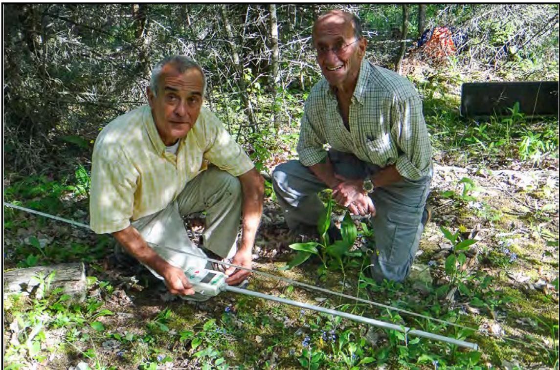
*Le Ceptomètre est maintenu à quelques centimètres au dessus du sol pour capter la lumière qui parviendrait à des semis de Sapin. Mis en œuvre par M. RIPERT de l'IRSTEA, sous le regard de M. CANCE représentant du GF propriétaire. Le capteur est aligné sur le ruban de chantier matérialisant le transect. Chaque carré d'observation est ainsi échantillonné. Photo L. AMANDIER.*
