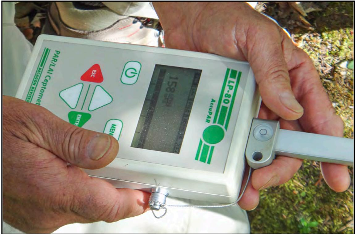
*Le ceptomètre est un instrument de mesure de la lumière incidente. Il enregistre les données issues d'une barrette de capteurs photosensibles longue d'environ un mètre. Le flux de photons est exprimé en moles/m<sup>2</sup>.seconde. Photo L. AMANDIER.*
