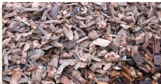
Plaquettes de scierie (source : www.ofme.org/bois-energie/ )
