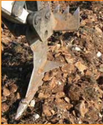
Le culti sous soleur Becker réalise un billon bombé grâce à sa dent en obus et à ses deux ailettes tranchantes décalées. Un peigne supérieur racle la partie superficielle du sol sans l'incorporer dans le sol de part et d'autre du bourrelet.
