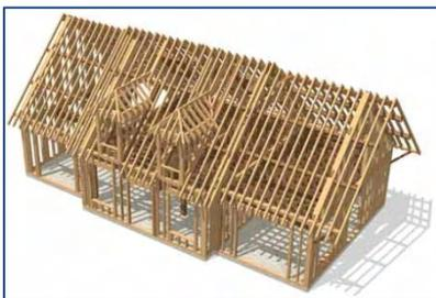
La maison ossature bois (MOB) consiste à ériger des parois dont les fonctions porteuses sont assurées par des éléments en bois de faible section, selon une trame régulière et faiblement espacée. L'ossature bois permet de remplacer l'acier et le béton pour tout type d'ouvrage. Elle peut être utilisée **pour tout type de bâtiment** : logements individuels, logements collectifs, bâtiments publics, ponts, etc.
