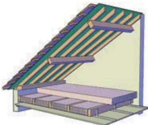
Comble perdu – Isolation d'un plafond (Source FCBA)
