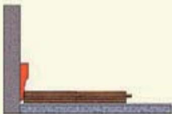
*Cale d'épaisseur minimum de 8 mm afin d'avoir un jeu régulier ; à la fin, les cales sont retirées et le jeu est caché par les plinthes.*
